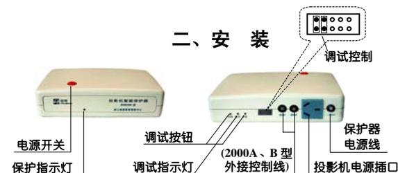
RHB2000 型保护器的安装非常方便，只要将保护器电源插头接入用户~220V 电源插座，将投影机电源插头插入保护器投影机专用电源插口即可（除投影机外，不能接入其它设备）。
