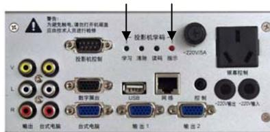
② 将投影机遥控器对准读码接收头（约 3-5 厘米），按一下需要学习的按键如 ON 键（只有 POWER 键的请按 POWER 键），这时学码指示灯熄灭（如没有熄灭，仔细调整遥控器与读码接收管距离，太近或太远会造成学码错误），说明投影机遥控器发送控制码成功。
